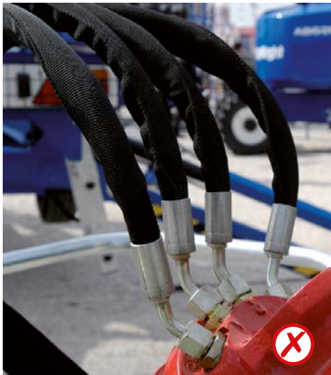
Abb. 21 Falsche Schutzschlauch-Montage: Schutzschläuche sind in die Armaturen mit eingebunden
