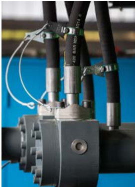
Abb. 18 Fangschutz-Seilverbindungen a) Fest montiert mit Hydraulik-Schlaucharmatur b) Nachrüstbar ohne Demontage der Hydraulik-Schlauchleitung
